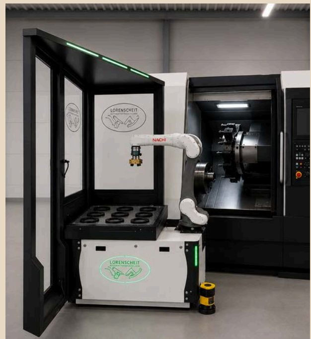
NACHHER – AUTOMATISIERTE BELADUNG
